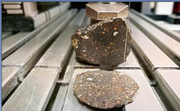
Abb. 1: Präzisionsschnitt - NWA CV3 (eigene Darstellung)
